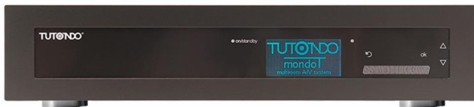
Centrale **MTAM816S** per il controllo e la gestione del sistema di diffusione sonora multiroom, dotata di 9 ingressi audio (8 centralizzati e 1 ingresso locale di zona), può gestire direttamente 6 ambienti (ampliabile fino a 48 zone con l'ausilio di 7 espansioni [MTAE816](#)).
