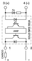
Moduli a relè a stato solido a canale singolo, tensione nominale: 5-12-24 Vdc (range 4...30 Vdc), tipo di collegamento: 1 non estraibile, tipo di contatto: transistor
