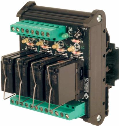
Moduli a relè elettromeccanici a canale multiplo, tensione nominale: 24 Vac/dc, tipo di collegamento: 4 estraibile, tipo di contatto: SPDT
