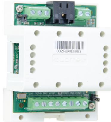
Modulo che consente la modulazione e l'invio del segnale video proveniente da fino a 8 telecamere (4 telecamere analogiche e 4 telecamere IP) per centrali della serie Vedo. Da abbinare all'art. VEDOIP. Dimensioni: 60x85x35 mm (4 moduli DIN).
