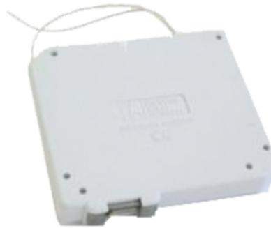
Sensore a filo per tapparelle dotato di sistema di analisi del segnale proveniente da due contatti interni al sensore. Collegamento con cavo a 4 conduttori (alimentazione e contatto di allarme). Utilizzabile anche con i trasmettitori wireless art. RFMAGAB e RFMAGW. Contatto NC in stand-by e NO in allarme. Tensione di alimentazione 2.8 - 13.8 VDC.
