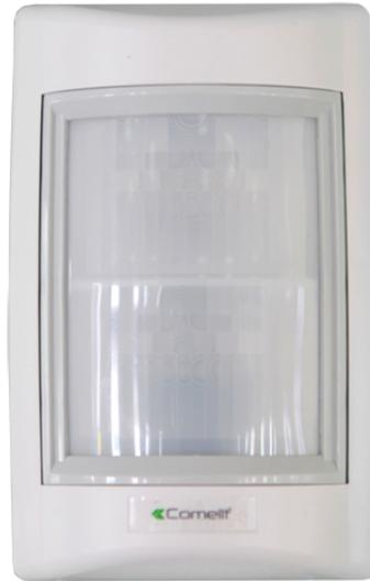
Doppio PIR con ottica effetto tenda a duplice elemento da esterno in tecnologia ASIC che permette un'analisi accurata per eliminare falsi allarmi, alimentazione da 9.6 a 16 VDC, assorbimento a riposo 8 mA, in allarme 18 mA, portata 22.5 metri con apertura 2.2 metri, temperatura di funzionamento da -25 a +55°C, protezione IP 65, uscita allarme e tamper NC.
