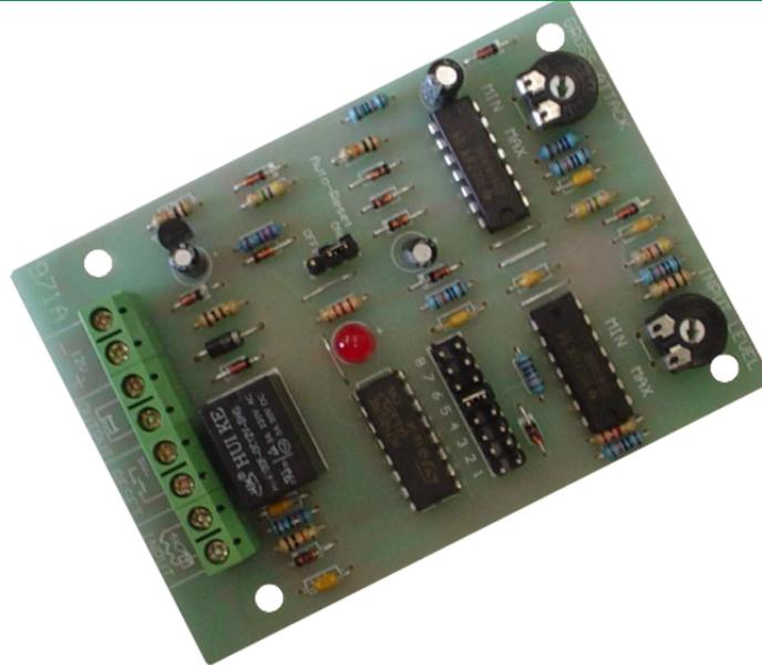
Scheda contaimpulsì per ingressi veloci. Alimentazione 10-15 VDC, assorbimento 45 mA, contatto NC, regolazione impulsì da 1a 8, velocità e sensibilità. Dimensioni: 65x90 mm.
