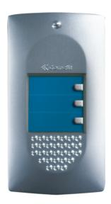
Posto esterno citofonico da incasso con frontale in alluminio anodizzato, ampio cartellino portanomi retroilluminato con led. Completo di portiere citofonico, regolazione dei volumi, generatore di chiamata, altoparlante stagno e microfono ad electret. Alimentazione 12 Vca. Dimensioni posto esterno: 95x176x15mm. Dimensioni scatola da incasso: 95.5x176,5x35mm
