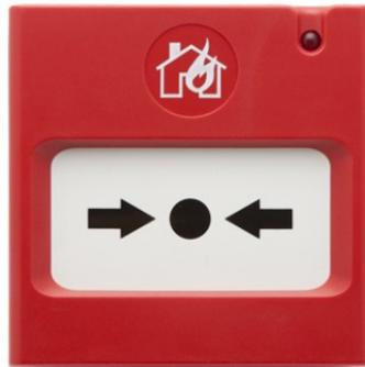
Punto di allarme manuale indirizzato con isolatore a bordo integrato. Il pulsante è dotato di un elemento operativo ripristinabile con chiave speciale plastica (in dotazione) ed invia una segnalazione di allarme alla centrale quando esso viene attivato mediante pressione nel punto segnalato. E' dotato di led per la segnalazione dello stato di allarme o di test. Montaggio a parete. Contenitore in ABS rosso. Certificazione secondo EN 54-11 e EN 54-17.
