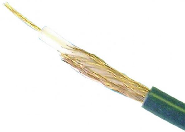
Cavo coassiale tipo RG11, impedenza 75 ohm, conduttore da 0,6 mm, schermo in rame, isolamento in polietilene solido, guaina in PVC, colore nero, adatto per tratte lunghe (max 600 m a colori).
