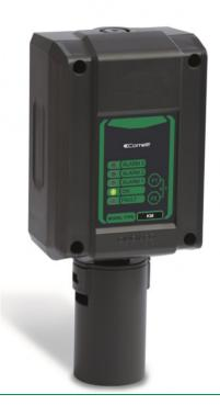
Rivelatore autonomo con sensore catalitico per la rilevazione di Idrogeno (H2) dotato di 3 relè di allarme e uno di guasto. Segnale d'uscita 4÷20mA e cartuccia sensore sostituibile. Alimentazione 12-24VDC. Grado di protezione IP65.
