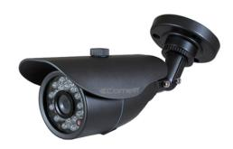
Telecamera AHD all-in-one a colori Day & Night, ottica fissa da 2.8 mm, risoluzione HD (720p), contenitore waterproof IP66, 18 illuminatori SMD ad infrarosso con portata di 25 metri.
