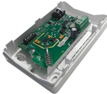
Moduli ricetrasmittitori radio che permettono di utilizzare i dispositivi wireless elencati nelle centrali Comelit della serie VEDO. Permettono l'utilizzo di fino a 10 sensori, 8 sirene e 16 telecomandi radio. Alloggiato in contenitore plastico antifiamma colore bianco completo di tamper antiapertura e anti-strappo escludibili. E' possibile alloggiarlo anche all'interno dei contenitori art. BOXPLASTIC, BOXMETAL e BOXFLUSH. Dimensioni (L x H x P) 126 x 80 x 32 mm.
