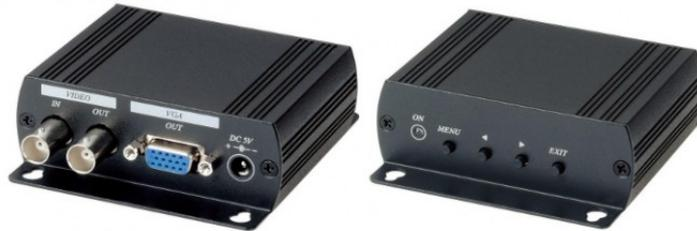
Convertitore attivo di segnale video composito (PAL/NTSC) in segnale VGA, 1 connettore tipo BNC ingresso video composito, 1 connettore VGA per uscita video, protezione ESD integrata, alimentazione 5 VDC, contenitore metallico, colore nero, alimentatore incluso.
