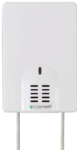
Sensore di allagamento, contenitore in ABS bianco, alimentazione 12Vdc, assorbimento 20mA in allarme, 15mA in st-by, lunghezza terminali esterni max 35mm, uscita relè selezionabile NC/NO, possibilità di collegamento di 8 sensori remoti a distanza massima di 100 metri, dimensioni 60x90x25mm.
