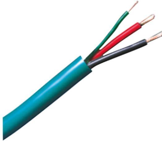
Cavo per il collegamento dei moduli che comunicano sul BUS 3 fili del sistema SimpleHome. 2 conduttori da 1mmq per l'alimentazione e 1 conduttore da 0,5mmq per il BUS di comunicazione. Schermatura in alluminio. Matasse da 100m.
