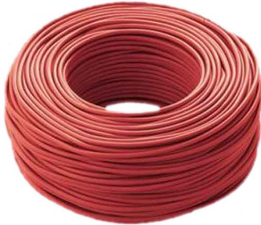
Cavo rosso da utilizzare per la realizzazione di sistemi antincendio, con grado di resistenza al fuoco PH120, matassa da 100m, sezione fili 2 x 1,5mmq. Certificazione secondo norma EN 50575:2016.
