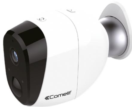
Telecamera IP Wi-Fi all-in-one a colori Day & Night, ottica fissa da 2.6 mm, risoluzione HD (720p)@25 ips, 11 illuminatori ad infrarosso con portata di 10 metri. Batteria ricaricabile, alimentatore e supporto magnetico da parete in dotazione. NOTA: NON compatibile con router TIM modello TG789VAC V2
