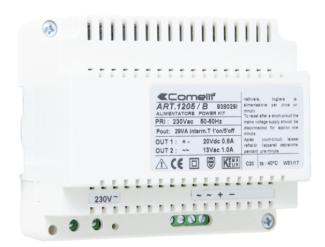
Trasformatore con 2 uscite: una per alimentare il posto esterno e l'elettroserratura e una per alimentare il monitor. Morsettiere: ingresso tensione di rete 230VAC, uscita VAC per posto esterno e elettroserratura, uscita 20VDC di alimentazione per il monitor. Dimensioni: 105x85x85mm.
