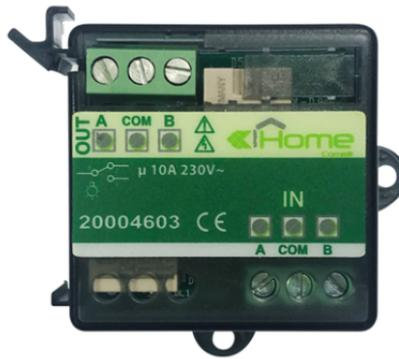
Interfaccia 2 uscite relè 10A NO/NC configurabili con unico comune di riferimento. Ideale per il comando di tapparelle o luci. Non adatto al comando di lampade fluorescenti, a LED o carichi gravosi. Da collegare su uscite a transistor 24VDC (ad esempio art.20004601 o art.20046502). Montaggio da incasso o guida DIN. Dimensioni 42x42x18mm (1 modulo DIN).
