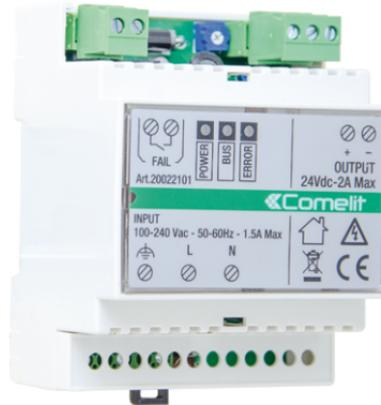
Alimentatore per sistema SimpleHome, parallelabile, auto protetto, 24VDC. Fornisce l'alimentazione ai moduli del sistema BUS SimpleHome. In grado di fornire fino a 2A e nel caso di maggiori assorbimenti è possibile collegare lungo il bus più alimentatori distribuiti in punti diversi dell'impianto, dispone di un contatto relè di uscita per segnalare il malfunzionamento, dimensioni 71x90x58mm (4 moduli DIN).
