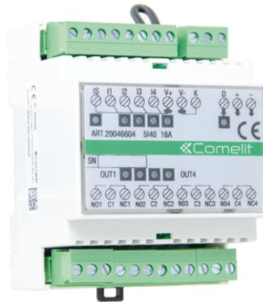
Modulo SimpleHome dotato di 5 ingressi optoisolati (4 normali + 1 scenario), utilizzabili per collegare i pulsanti nei pressi del quadro elettrico e di 4 uscite a relè con contatto in scambio NC/NO per comandare carichi elettrici di tipo resistivo fino a 16A. Dimensioni 71x90x58mm (4 moduli DIN). Assorbimento max 140mA.
