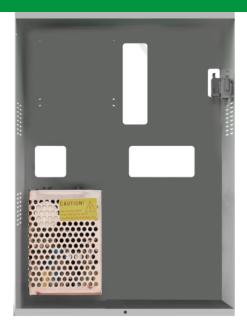
Contenitore metallico completo di alimentatore, tensione di ingresso 230 VAC, tensione di uscita 13.8 VDC, corrente massima erogabile 1.5 A, completo di alloggio per batteria da 7 o 18 Ah, dotato di tamper anti-apertura. Dimensioni 315  $\times$  440  $\times$  95 mm.
