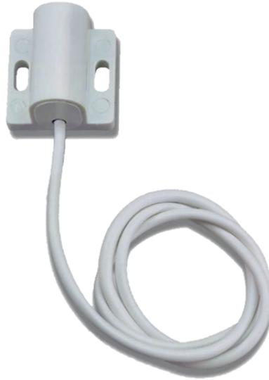
Sensore inerziale in materiale plastico ad alta sensibilità. Il contatto deve essere collegato ad ingressi veloci. Dimensioni: 33x33x23.5mm.
