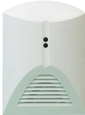
Sensore microfonico di rottura vetri. Attraverso un microprocessore elabora i suoni rilevati da un preciso microfono ed invia la segnalazione di allarme alla centrale. Protezione tamper antiasportazione. Alimentazione 7,5 - 15 VDC. Corrente assorbita durante il normale funzionamento 5mA, max 80mA (in allarme). Dimensioni: 92x59x27mm. Peso 100g.
