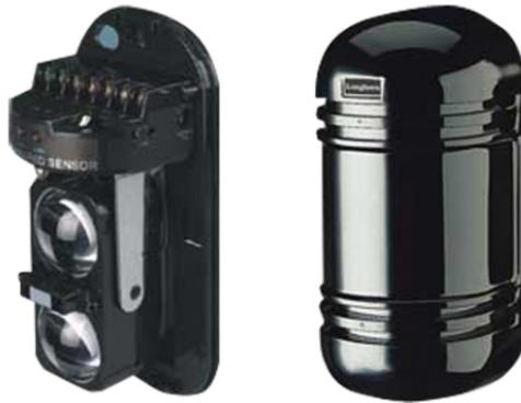
Coppia di sensori fotoelettrici doppio raggio per impiego in ambienti interni o esterni. Tensione di alimentazione 12÷24Vdc. Corrente assorbita durante il normale funzionamento 18mA. Angolo di allineamento verticale 20°. Portata 180m (interno), 60m (esterno). Angolo di allineamento orizzontale 180°.
