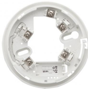
La base standard per rivelatori indirizzati ha un design a basso profilo ed un sistema di collegamento al sensore estremamente affidabile consentendo anche un bloccaggio di sicurezza del rivelatore. Sezione massima dei cavi utilizzabili: 3.0 mm<sup>2</sup>. Temperatura di funzionamento -10 °C / +60 °C. Umidità relativa di funzionamento: (93 ± 3) % @ 40 °C. Dimensioni: 103x14,7 mm. Peso: 15 g.
