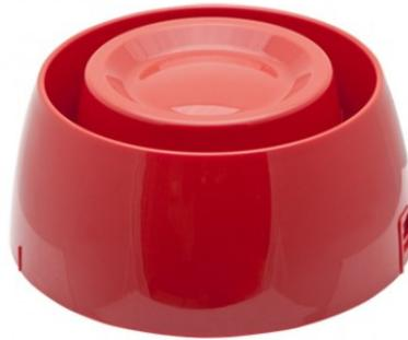
La sirena indirizzata 41SAI000, con isolatore a bordo integrato, è alimentata dal loop ed è controllata dalla centrale per mezzo del protocollo di comunicazione. Per il montaggio è necessaria la base standard per i rilevatori indirizzati 41RBX020. Sirena adatta anche per installazioni in esterno, grazie all'utilizzo della base grado IP65 Art. 41BSE000. La sirena è inoltre dotata di isolatore integrato. Certificazione secondo EN54-3 e EN 54-17.
