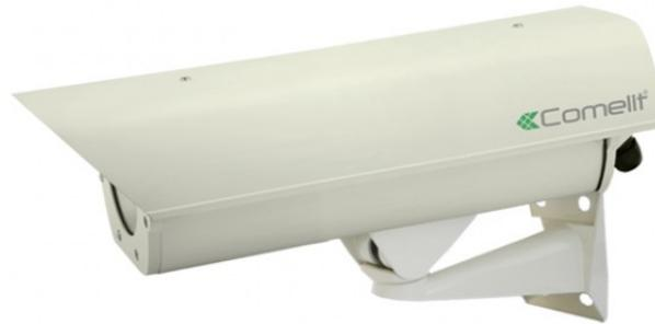
Custodia stagna da esterno/interno con tettuccio parasole, riscaldamento termostato, alimentazione 230 Vca, apertura laterale, contenitore in ABS e alluminio pressofuso estruso, waterproof IP66, colore beige, dimensioni utili (L x H x P) 97 x 87.5 x 210 mm, peso 1.5 kg. Staffa e snodo inclusi.
