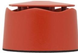
Sirena da esterno con elevata resa acustica e basso assorbimento con 32 toni selezionabili. Potenza sonora max. 110dB a 1m. Consumo max. 39mA. Grado di protezione IP66 (staffa di fissaggio art. 48SAE001 per grado IP66 non inclusa). Tensione di alimentazione 9-30 Vdc. Dimensioni 92mm (diametro) x 95mm. Certificazione secondo EN 54-3.
