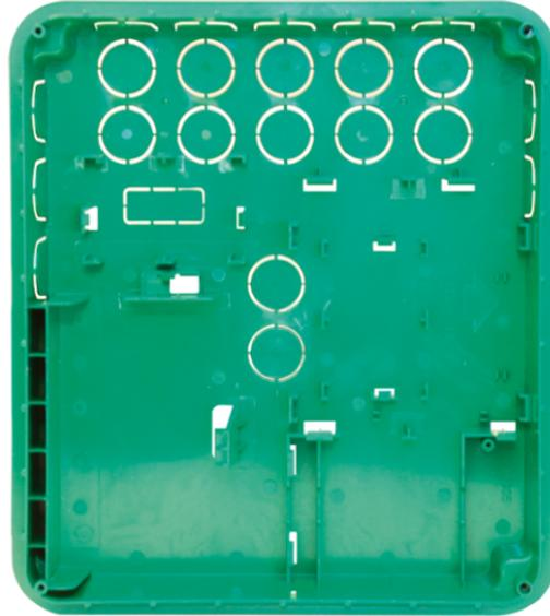
Contenitore da incasso in plastica antifiama per schede centrale serie Vedo art. PCBVEDO10, PCBVEDO34 e PCBVEDO68. Colore coperchio bianco RAL 9003. Prevede l'alloggiamento per la batteria da 7 A/h, l'alimentatore art. PSU15 e per un massimo di 2 schede espansioni su bus. Dimensioni (L x H x P) 335 x 295 x 70 mm.
