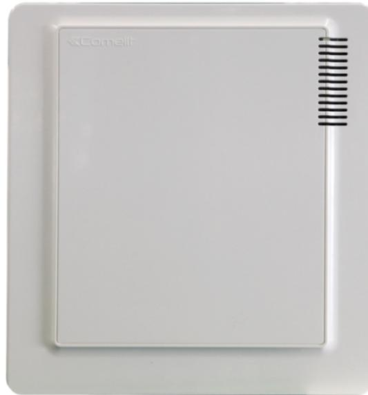
Contenitore da parete in ABS antifiamma per schede centrale serie Vedo art. PCBVEDO10, PCBVEDO34 e PCBVEDO68. Colore bianco RAL 9003. Prevede l'alloggiamento per la batteria da 7 A/h, l'alimentatore art. PSU15 e per un massimo di 2 schede espansioni su bus. Dimensioni (L x H x P) 260 x 280 x 80 mm. EN50131 grado 2
