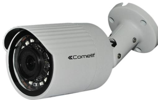
Telecamera IP bullet a colori Day & Night, ottica fissa da 3.6 mm, risoluzione 4MP@30 ips, contenitore waterproof IP66, 16 illuminatori ad infrarosso SMD con portata di 30 metri (SMART IR), compatibile ONVIF 2.2.
