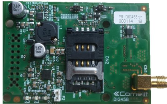
Scheda di espansione comunicatore GSM plug-in per centrali serie Vedo. Supporto reti 3G. Permette l'invio delle chiamate telefoniche, degli SMS, degli MMS e delle e-mail sulla rete dati. Abbinata alla scheda messaggi vocali art. VEDOVOICE, consente la gestione da remoto della centrale tramite SMS e comunicatore vocale. Articolo certificato in grado di sicurezza 2 secondo norma EN50131
