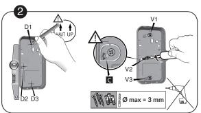
② Tracciate e perforate i fori D1, D2 e D3. Fissate la base con le viti V1, V2 e V3.
