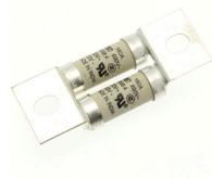
**Cartuccia fusibile, corsa rapida, 160 A, AC 690 V, DC 500 V, 200 kA, BS88, 37 x 94 mm, aR, BS**
