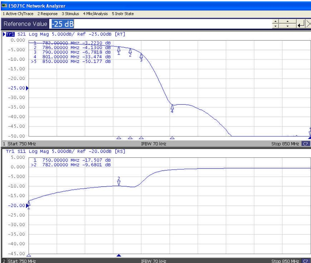
Dettaglio della selettività del filtro span 100MHz e relativo return loss d'ingresso del filtro
