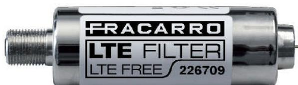
Filtro in linea da esterno per il filtraggio delle frequenze da 790 MHz a 862MHz. Il filtro, appositamente realizzato per adeguare gli impianti di distribuzione d'antenna alle trasmissioni LTE, è realizzato su meccanica da esterno con grado di protezione IP66. I connettori F maschio e Femmina consentono l'installazione dello stesso subito a Valle dell'antenna oppure all'ingresso dei centralini.
