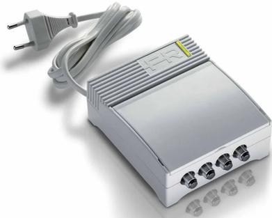
Amplificatore con 1 ingresso (VHF+UHF) da interno autoalimentato con guadagno 20dB e livello di uscita fino a 108dB $\mu$ V in banda UHF, regolazioni del livello (15dB) e bassa figura di rumore.
