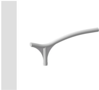
Staffa testa palo singola realizzata in tubolare di acciaio, di spessore 3 e 4 mm, zincato a caldo e verniciato a polveri poliesteri. Fornita con tre grani M8 INOX per il fissaggio su pali di diametro 60 mm.
