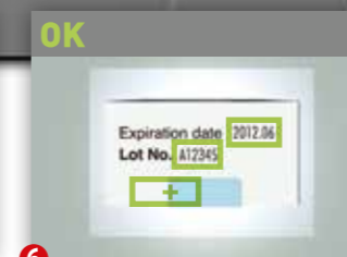
6 Verifica della data e rilevamento del nastro
