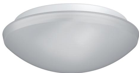
Plafoniera per lampada con attacco E27 che si accende mediante rivelatore di movimento HF integrato, in grado di intercettare ogni più piccolo movimento grazie alla tecnologia ad alta frequenza. Quando cessa il movimento, la luce si spegne trascorso un tempo di ritardo impostabile. Il rivelatore si attiva soltanto quando le condizioni di luce sono inferiori al livello selezionato.
