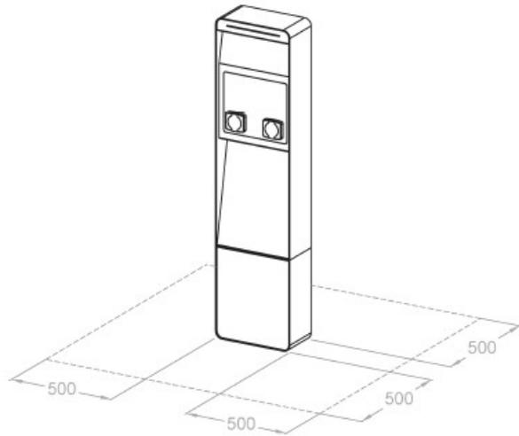
È necessario mantenere una distanza di circa 0,5 metri dalle pareti o altri ostacoli per garantire l'accessibilità alla stazione e per le attività di manutenzione
