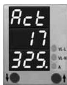
Misura delle potenza in Watt. Sulla seconda riga sono visualizzate le migliaia e sulla terza le unità. Nell'esempio, sono rappresentati 17325 W (17,325kW).
