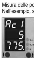
Misura delle potenza in Watt. Sulla seconda riga sono visualizzate le migliaia e sulla terza le unità. Nell'esempio, sono rappresentati 5775 W (5,775kW).
