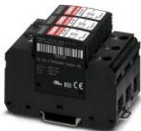
Scar. di sovratens. per sistemi a tens. continua isolati a 2 poli 1500 V DC, per mont. su guida di supp., elemento base a 3 poli, tre elementi di protez. estraibili controllati termicamente, messaggio di stato su ogni conn.
