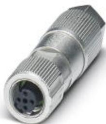
Connettori, PROFINET CAT5 (100 MBit/s), 4-poli, senza alogenati, schermata, Femmina diritto M12 SPEEDCON, codifica D, Connessione a perforazione di isolante, materiale zigrinato: Pressogetto di zinco, nichelato, diametro esterno cavo 5 mm ... 9,7 mm
