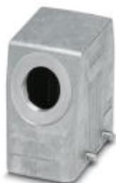
Custodia protettiva B10, per bloccaggio trasversale, materiale: Pressofuso di alluminio, impermeabile, uscite cavi: 1, laterali, altezza: 72 mm, connessione a vite per cavo: senza, perno: no, 1x Pg21, Standard
