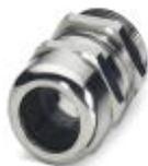
Connessione a vite per cavo, materiale viti: Ottone, nichelato, diametro esterno cavo 13 mm ... 18 mm, schermatura: sì, filettatura: Pg21, colore: argento, con O-ring
