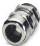
Connessione a vite per cavo, materiale viti: Ottone, nichelato, diametro esterno cavo 13 mm ... 18 mm, schermatura: sì, filettatura: Pg21, colore: argento, con O-ring
