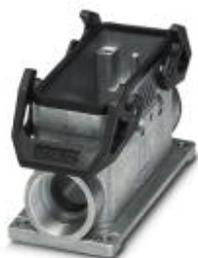
Custodia a zoccolo B16, con blocc. trasversale, materiale: Pressofuso di alluminio, impermeabile, uscite cavi: 2, laterali, altezza: 68 mm, connessione a vite per cavo: senza, perno: no, 2x Pg21, Standard
