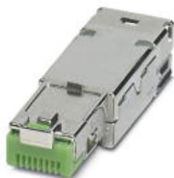
Pezzo di ricambio, grado di protezione: IP20, numero poli: 8, 1 Gbit/s, CAT5 (IEC 11801:2002), materiale: Pressofuso di zinco, collegamento: Connessione rapida IDC, sezione di connessione: AWG 23- 22, uscita cavo: diritto
