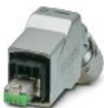
Connettore Push-Pull (versione 14), pressofuso di zinco, con inserto connettore RJ45 8 poli, con connessione rapida IDC, per condutt. a 1 e 7 fili AWG 23 ... 22, per diametro cavo 5,5 mm ... 10 mm
