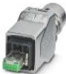
Connettore Push-Pull (versione 14), pressofuso di zinco, con inserto connettore RJ45 8 poli, con connessione rapida IDC, per condutt. a 1 e 7 fili AWG 23 ... 22, per diametro cavo 5,5 mm ... 10 mm
