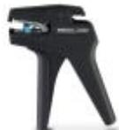
Pinza spelafili, per cavi e conduttori con sezione da 0,08 a 2,5 mm, autoregolabile, lungh. di spelatura regolabile fino a 15 mm, capacità di taglio fino a 6 mm<sup>2</sup> flessibile/1,5 mm<sup>2</sup> rigido
