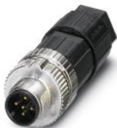
Connettori, Universale, 5-poli, non schermata, Maschio diritto M12, codifica A, Connessione Push-in, materiale zigrinato: Pressogetto di zinco, nichelato, diametro esterno cavo 4 mm ... 8 mm
