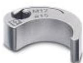
Inserto a innesto per il montaggio di cavi sensori/attuatori con connettori M12 e di connettori M12 confezionabili, con diametro della ghiera di 15 mm, per comando esagonale da 4 mm
